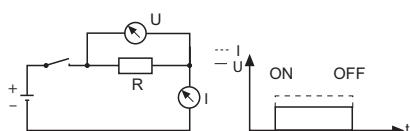
Вольт-амперная характеристика при коммутации катушки реле (рис.2).
